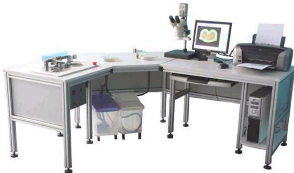
图 3-2 线束端子显微图像摄取装置
